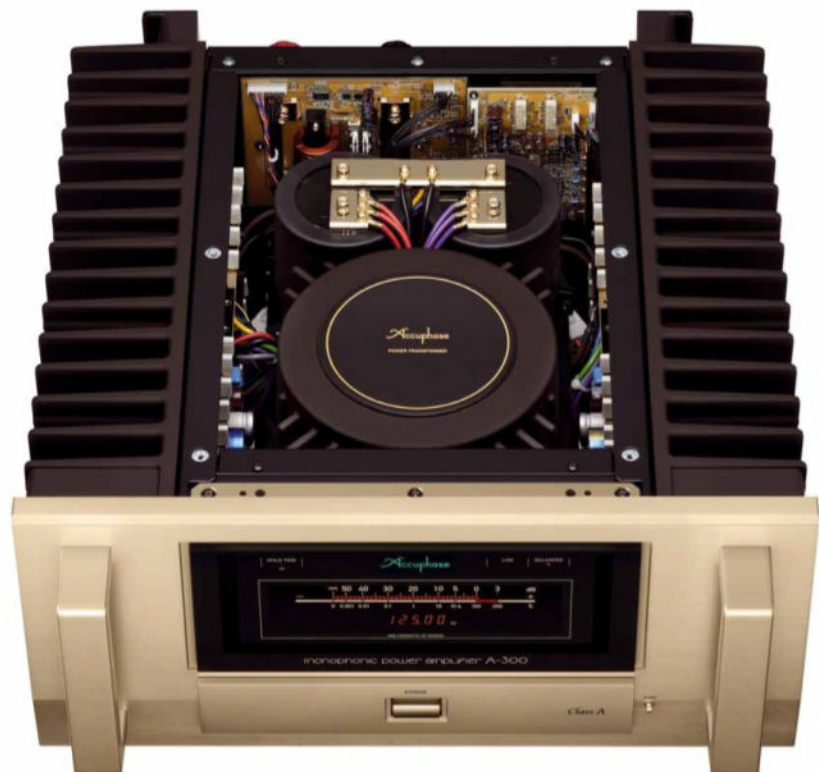
Der Netztrafo des neuen Topmodells sitzt im Unterschied zur A-250 vorne im Gehäuse
